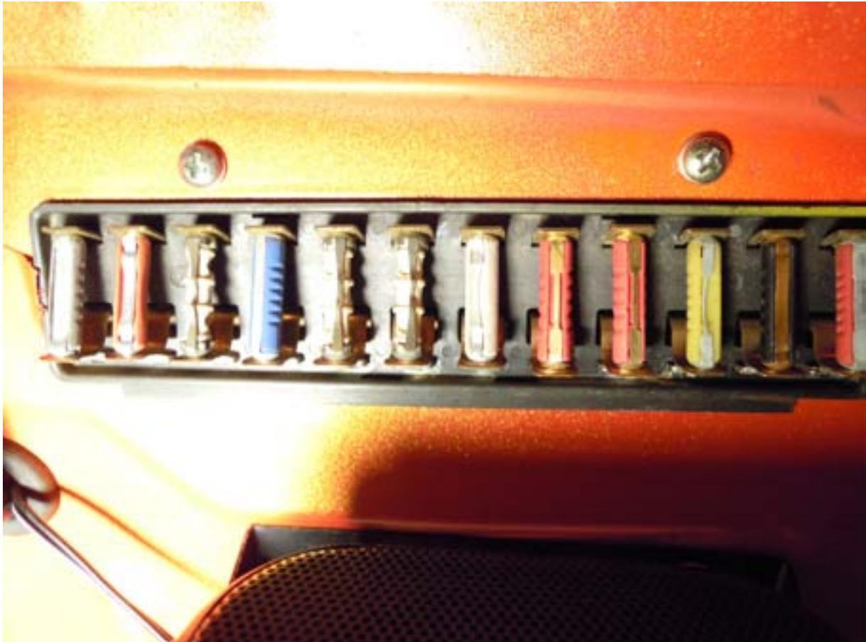
**Da der Radio defekt war, wollte ich einen neuen moderneren Radio in den Käfer einbauen. Doch hier schaffte ich den ersten Kurzschluss. Somit wurden die ersten zwei Sicherungen am 24.04.2011 ersetzt.**
